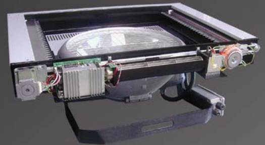
Schrittmotor, Steuerungselektronik, Lüfter und Netzteil (v.l.n.r.)
