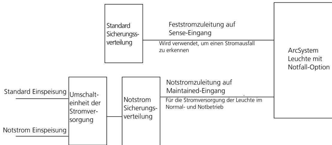
Der Sense-Eingang wird verwendet, um zu erkennen, ob die normale Versorgungsspannung ausgefallen ist. Dadurch wird die Leuchte mit einer Intensität von 100 % eingeschaltet, die von der aufrechterhaltenen Stromversorgung stammt. Die Leuchte kann nicht über das drahtlose oder drahtgebundene DMX gesteuert werden, bis die normale Versorgungsspannung am Sense-Eingang wiederhergestellt ist.
